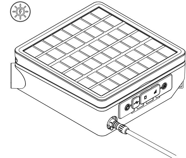
**i** Le connecteur est un connecteur Snap-In, il a un sens unique de branchement, si vous sentez une résistance, tournez le connecteur afin d'aligner l'embase mâle avec l'embase femelle pour verrouiller le branchement.
