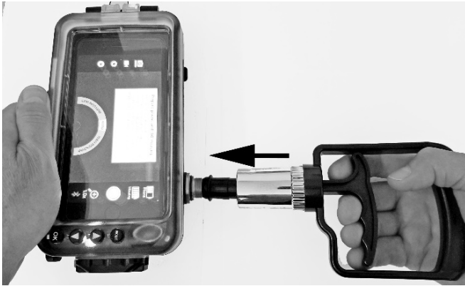
Handpumpe gegen den Vakuum-Checkport drücken
